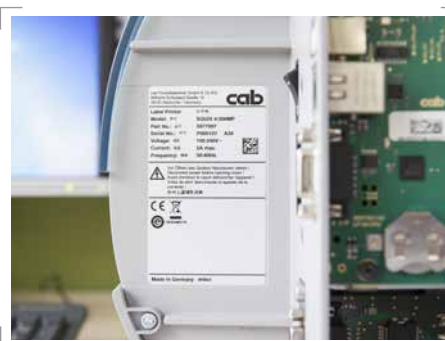
Identificación de placas de características
